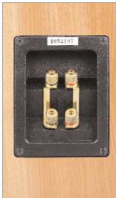
Terminale głośnikowe są standardowe, podwójne. Warto wyjąć blaszane zworki i zastąpić je krótkimi odcinkami zwykłych przewodów głośnikowych
